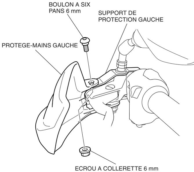
8. Serrez les boulons selon les spécifications indiquées dans le tableau des couples.
